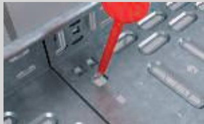
Umbiegen der Sicherungslaschen im Boden.
