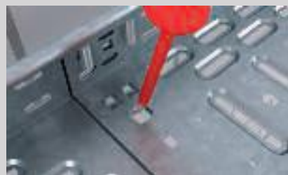
Schraubenlose Stoßstellenverbindung, nur Umbiegen der Bodenlatten erforderlich.
