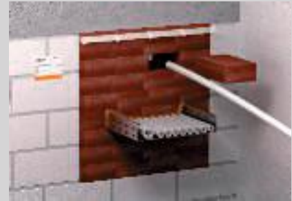
Einfache Nachinstallation durch Herausziehen einzelner Blöcke.
