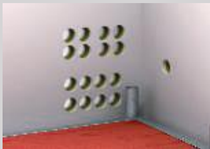
Gruppenweise Anordnung der Bohrungen.
