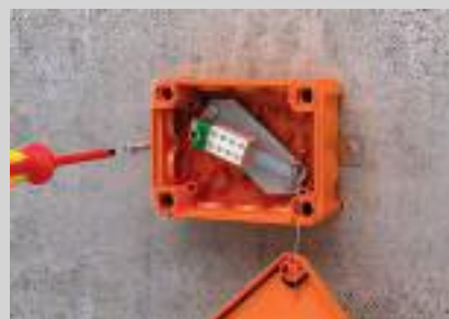
Schnelle Deckelmontage durch 90°-Drehung der Eckschrauben.
