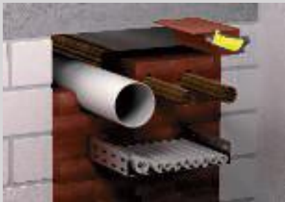
Durchführung brennbarer Rohre ohne zusätzliche Maßnahmen.
