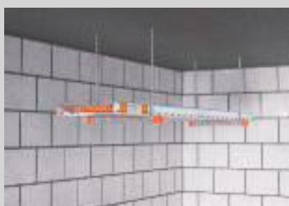
Einlagige Deckenmontage mit U-Querprofil.
